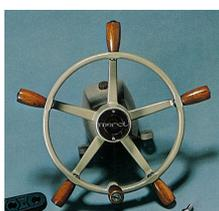
重労働だった漁船など小型船舶の舵取り。この仕組みを油圧化することで負担を画的に改善する操舵装置を開発。紆余曲折を乗り越えて製品化しました。その後ユーザーの要望と技術の発展により、エンジンの操作をリモコン化するエンジンリモコンや、目的にまで自動で舵を取るオートパイロットなど様々な機器が誕生しました。
