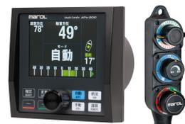
バラバラだった舵やエンジンの操作に加え、複雑化する操船機器をトータルでコントロールする機器を開発販売開始。容易に船舶を一定位置に留めることで漁や船釣りの操船が飛躍的に簡単になりました。
