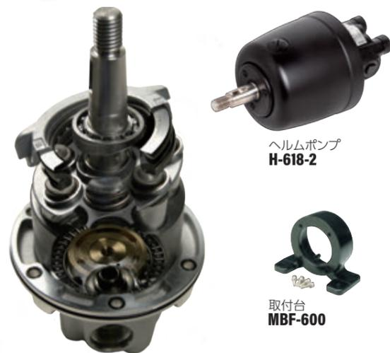
小さな力でスムーズに動く手動油圧操舵システム。そのパワー源は新設計の H-600 ヘルムポンプ。バランスピストンと中実プランジャーを採用することで、より安定した操舵力と、シャープな操作感を実現すると共に、強固なベアリングとステンレスシャフトにより高い耐久性を誇ります。
